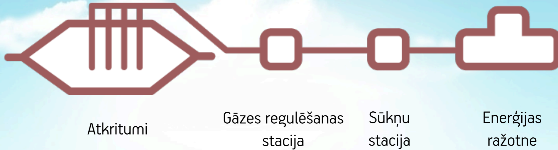
Vertikālo cauruļu gāzes ieguves sistēma
